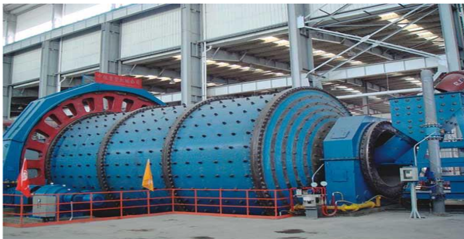
Сурет 1.7.2-шар диірмені Ø 6,2×9,5 м, 2 дана, 6000 кВт
