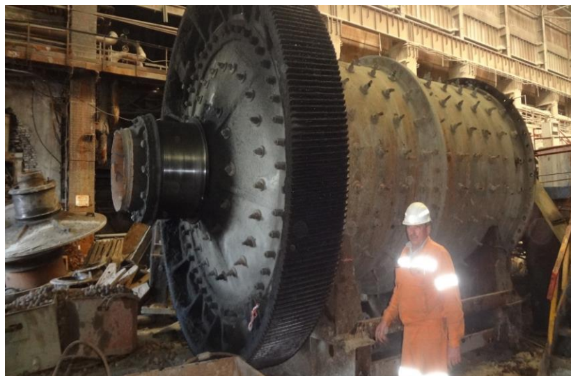
1.6-сурет-күрделі жөндеу кезіндегі шарлы диірмен
